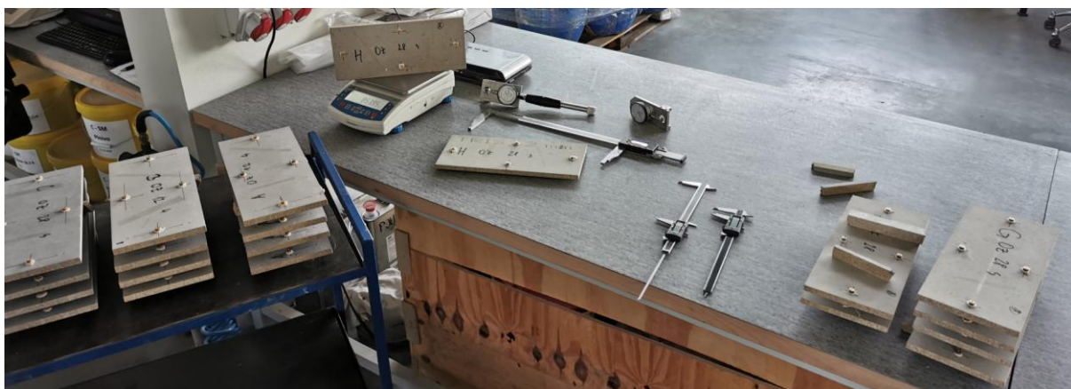
Obr. 3 : Příprava zkušebních těles pro testování objemových změn vlivem kolísání vzdušné vlhkosti
