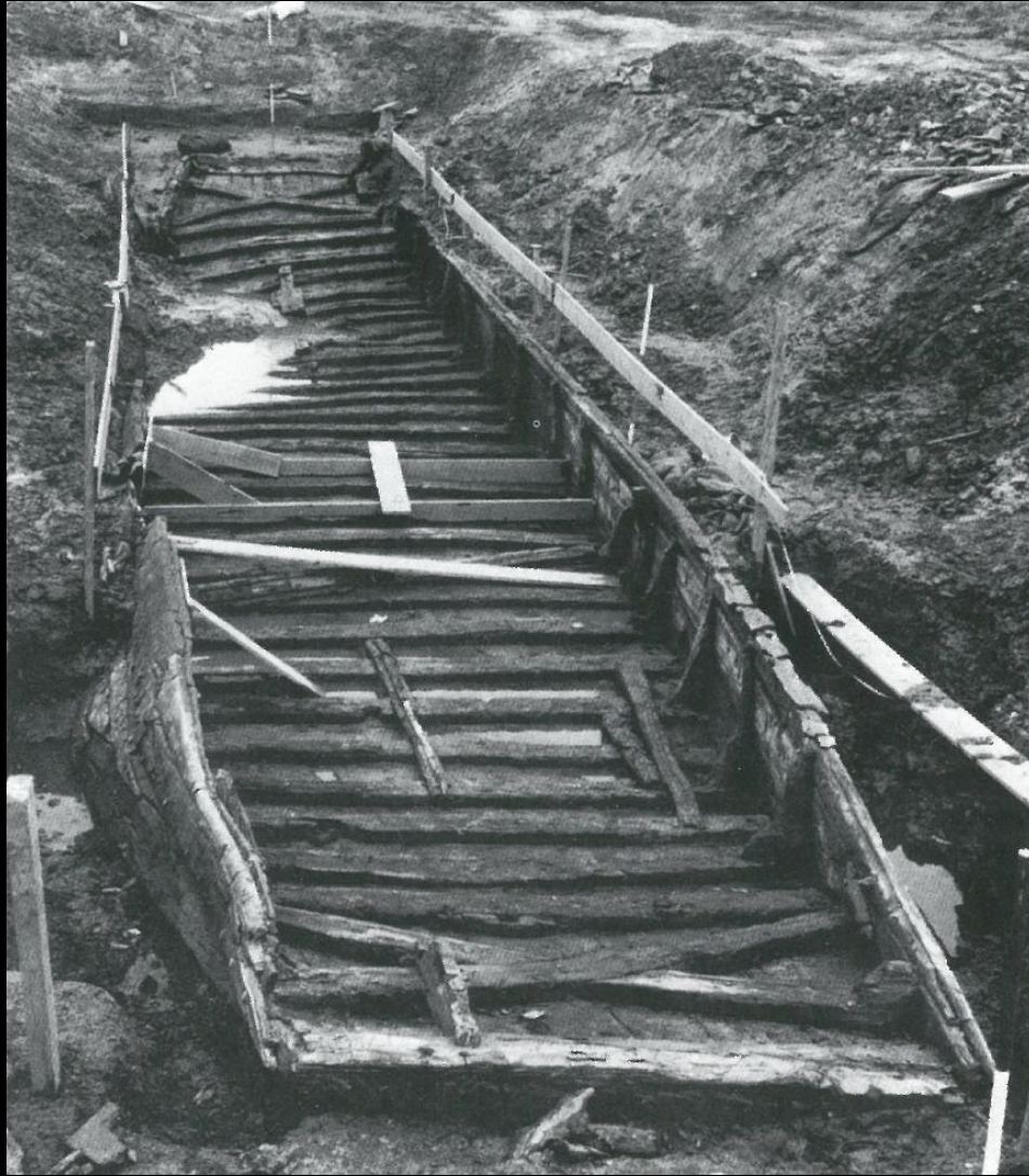
Říční pramice typu Zwammerdam 2 (Nizozemsko), 2/3. st. n. l. 23 m délka, 30 tun nákladu
