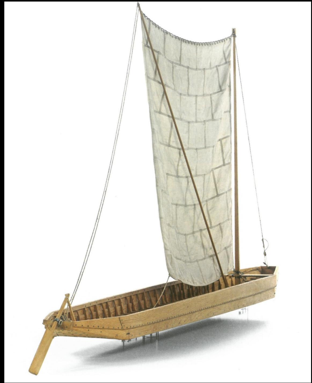
Říční pramice typu Zwammerdam 2 (Nizozemsko), 2/3. st. n. l. 23 m délka, 30 tun nákladu
