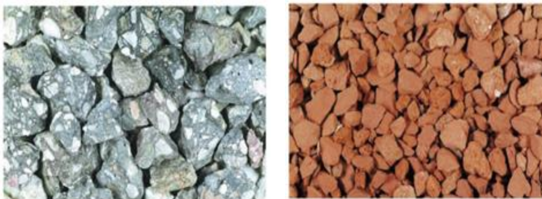
Obr.1 Betonový recyklát (vlevo), cihelný recyklát (vpravo)
