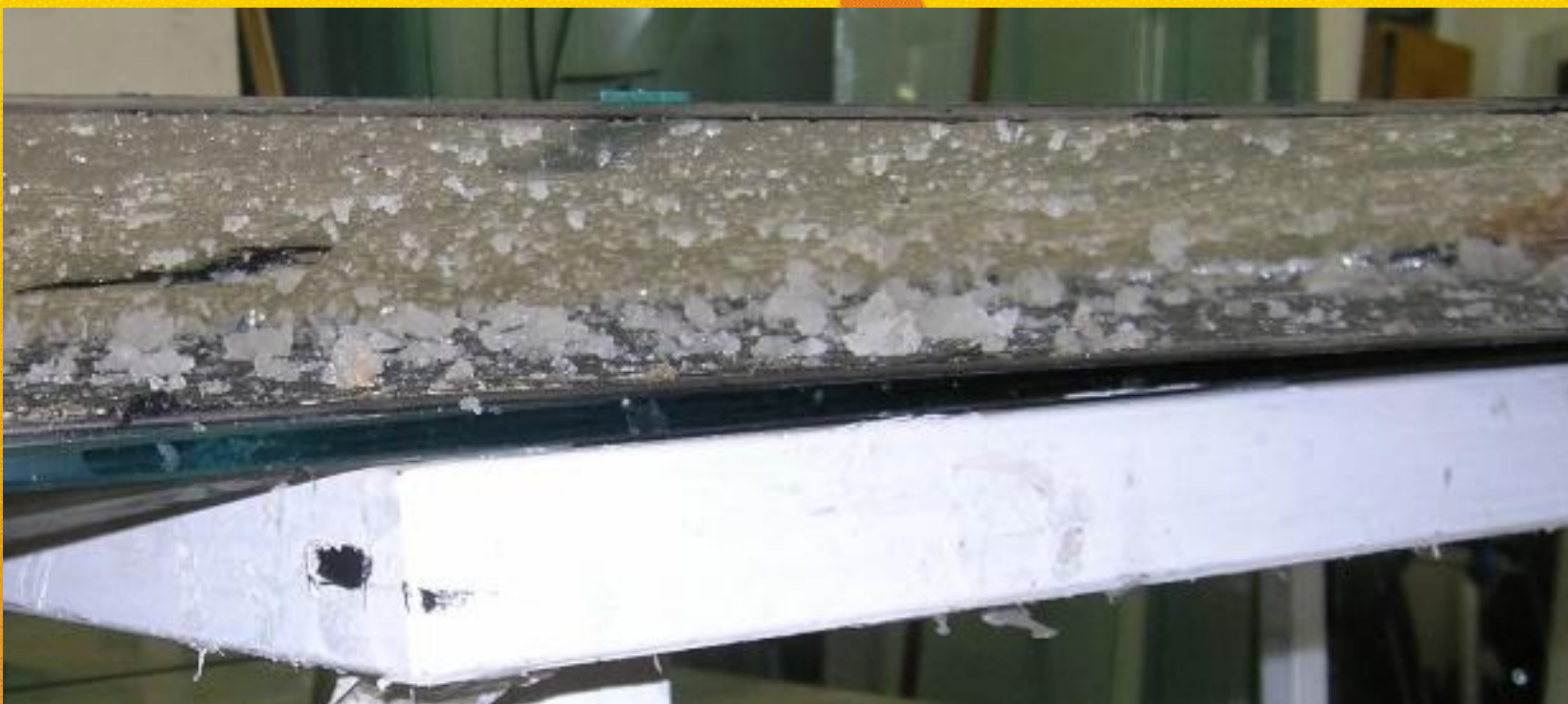
Obr. 3. Měkké siloxanové klastry lze snadno sbírat a recyklovat na silikonový kaučuk
