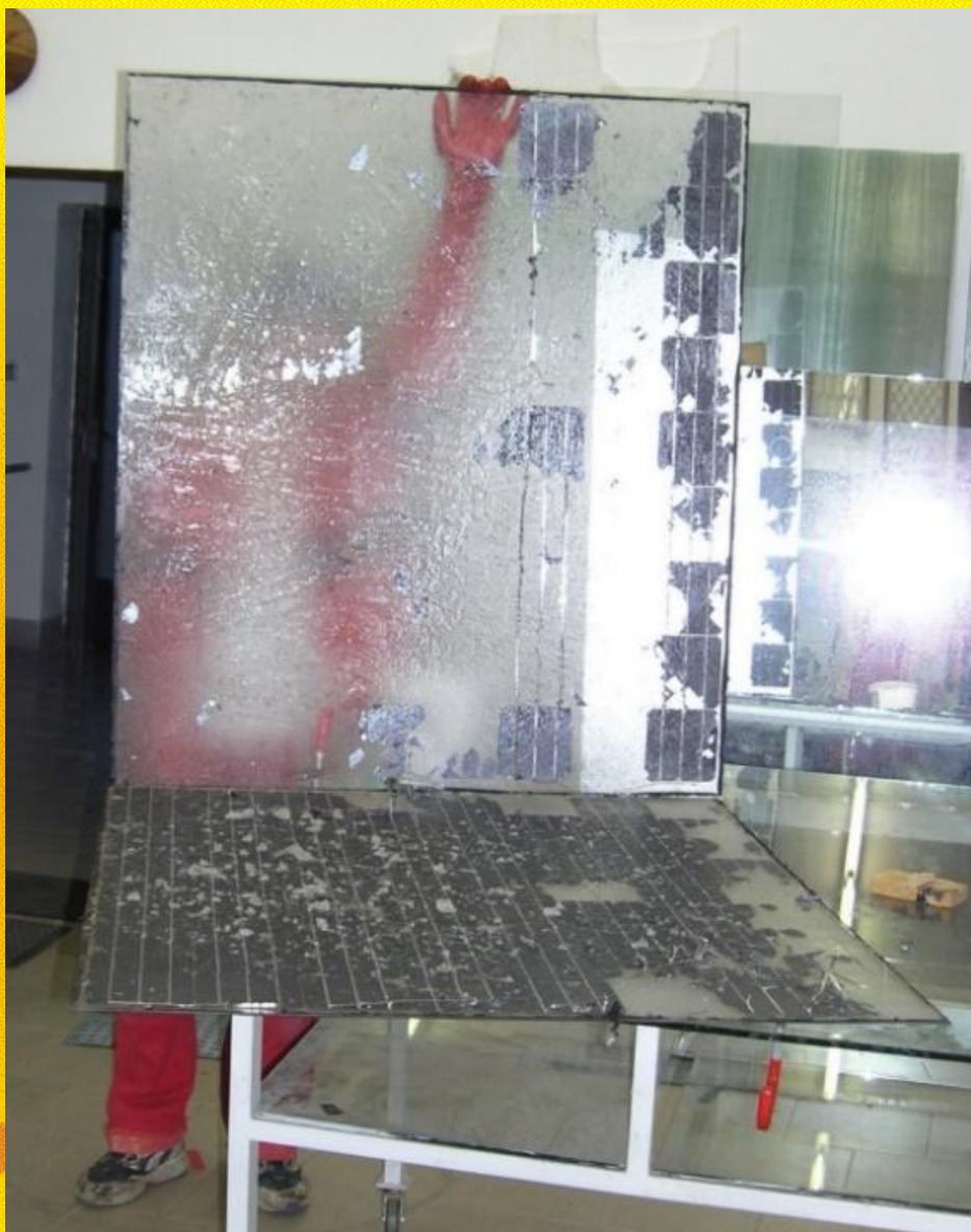
Obr. 2. Oddělené nepoškozené skleněné tabule se zbytky siloxanového gelu
