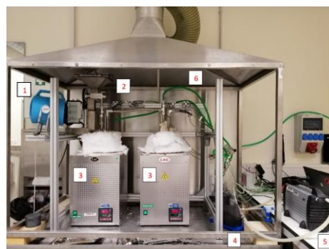
Obrázek 1. Schéma a fotografie laboratorní aparatury MSO, 1 - hnací plyn (vzduch), 2 - dávkovač pelet, 3 - reaktorová nádoba, 4 - vodní bublinky, 5 - vývěva, 6 - ventilace.
