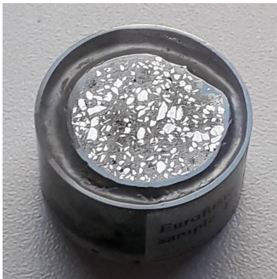
Obrázek 8. Řez vzorkem ze slinutého wolframu.
