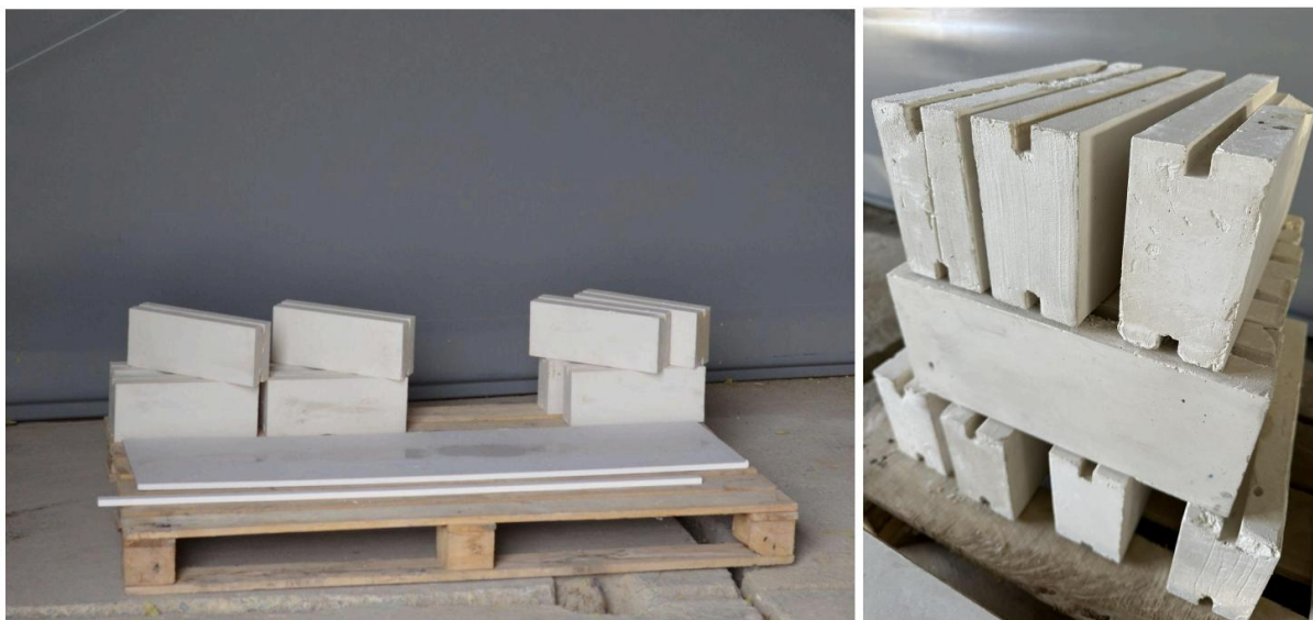
Obr. 1: Vyrobené sádrové bloky před vyzdíváním.
