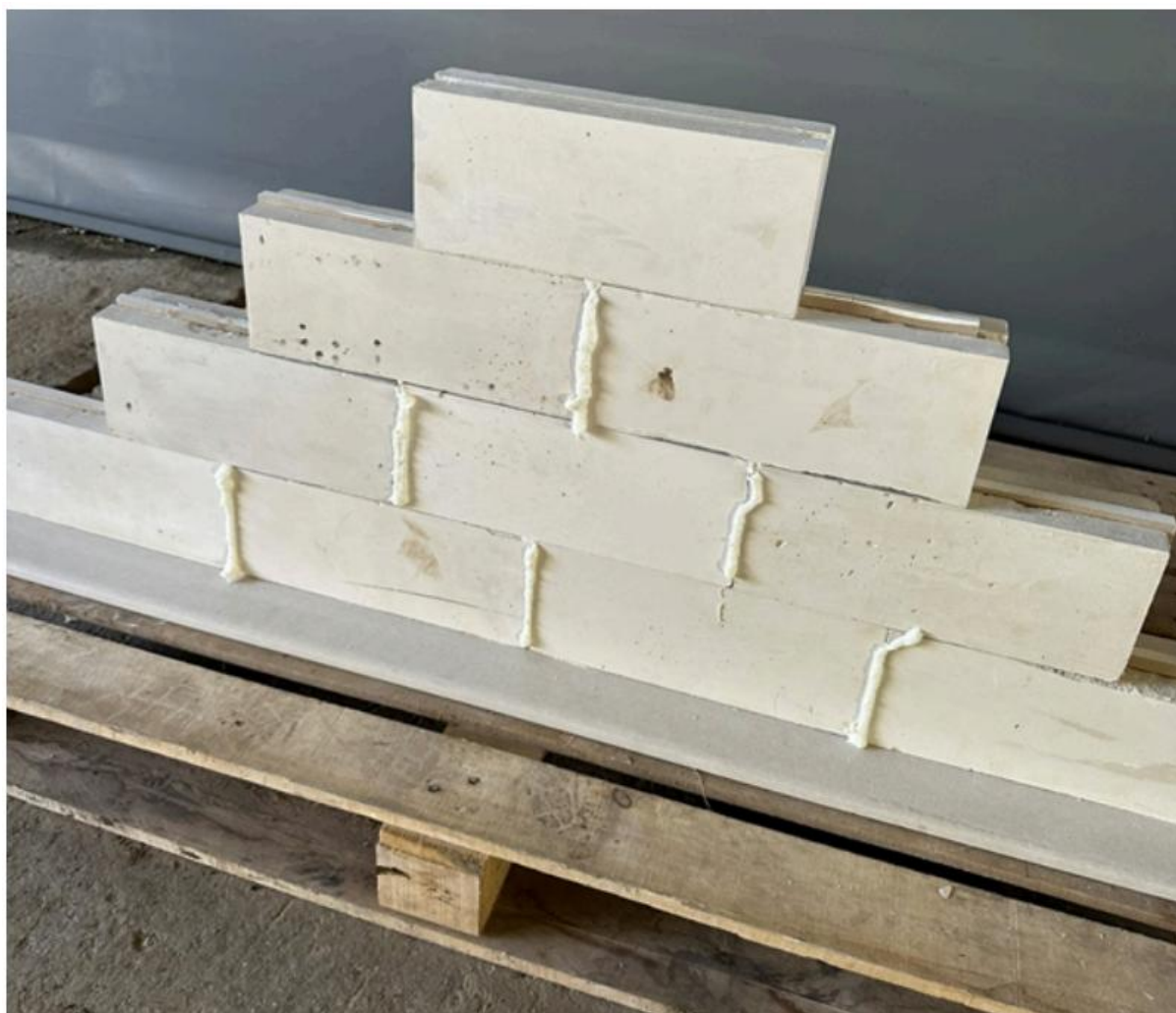
Obr. 4: Vyzdívání stěny z vyrobených sádrových bloků. PU pěna v styčných spárách.
