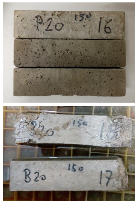
Obr. 3 Stav zkušebních těles po 150 cyklech
