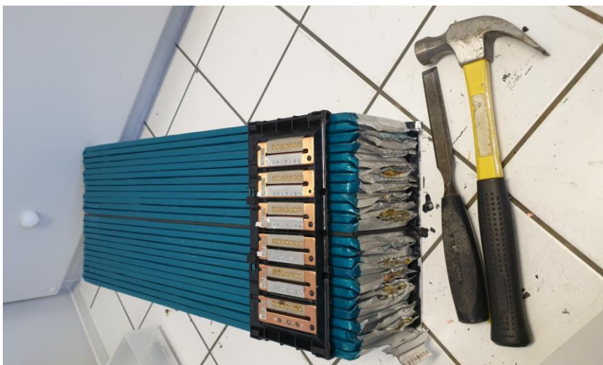
Obr. 1: Odhalené pouch články v modulu od fy LG užívaných ve vozech koncernu Volkswagen
