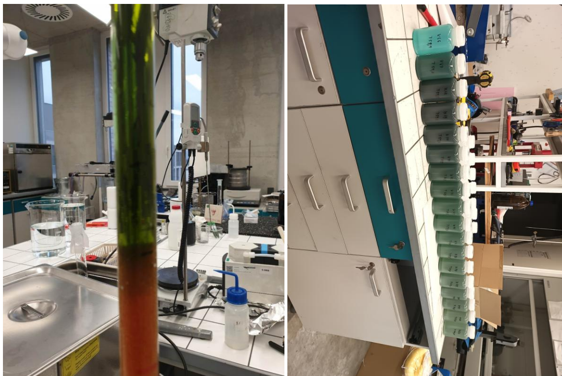
Obr. 2: Ukázka dělení směsi kovů na iontoměničové koloně pomocí chromatografického efektu
