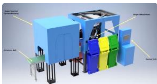
Obr. 5: Systém snímania a triedenia komunálneho odpadu Delta robotom
