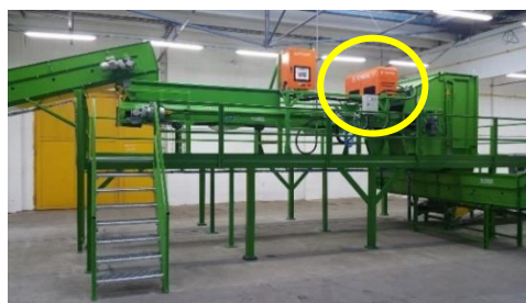
Obr.1 : Triediaca linka na ZKO / PKO a výstupy z jej spracovania (vybrané polyméry a Fe/NoFe)
