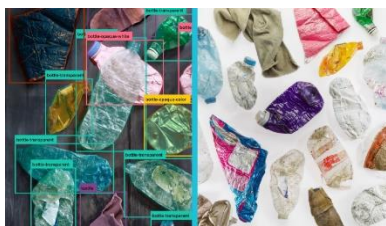
Obr.5: Systém videnia predmetov systémom GainNext od spoločnosti Tomra.
