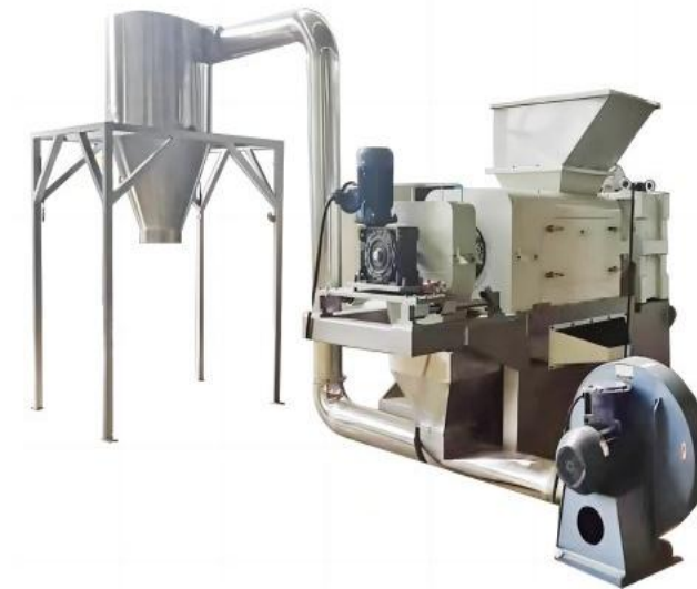
„Squeezer“ na zpracování separovaného plastu z OV a výsledný granulát
