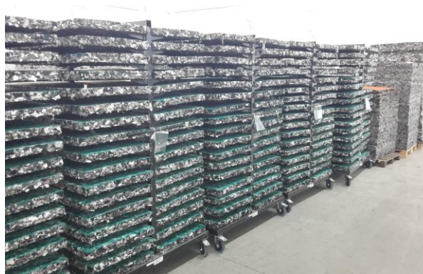
Obr.17 Lisované chumáče s pojivom do dosky STERED ID
