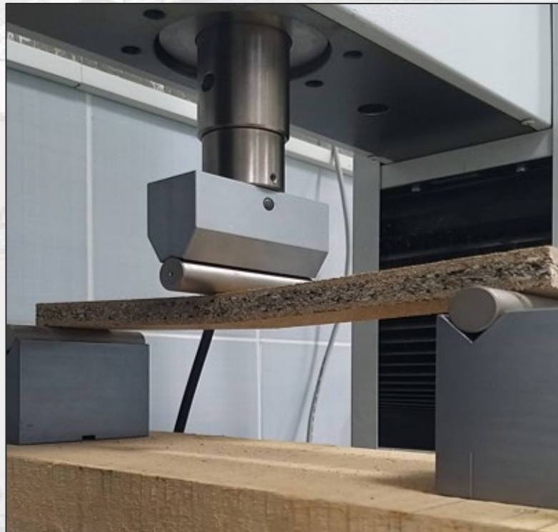
Obr. 6 Princíp merania pevnosti v ohybe
