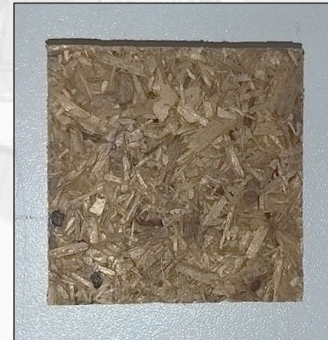
Obr. 3 Vzorka pre pevnosť v ťahu, hustotu, napúčanie a nasiakavosť
