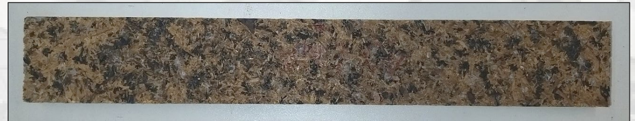
Obr. 4 Vzorka pre pevnosť v ohybe
