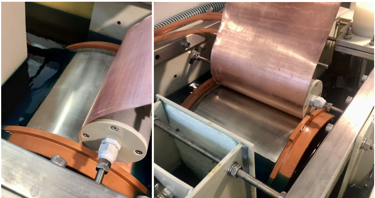
Obrázky 4 a 5. Poloprovodní výroba měděné fólie systémem EICuRe.
