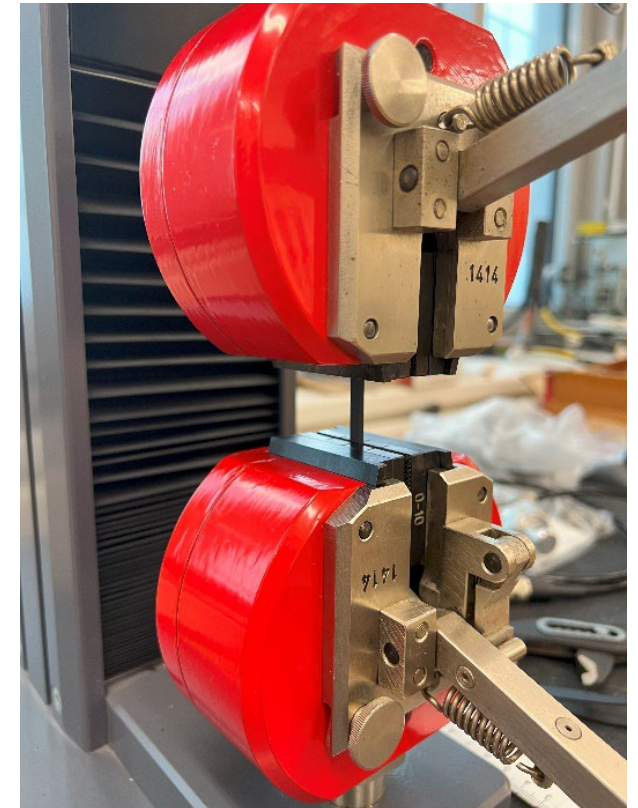
Vzorky dle ČSN EN ISO 527-2:2012, typ 1BA
