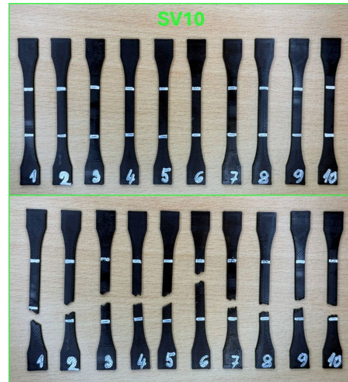
Vzorky dle ČSN EN ISO 527-2:2012, typ 1BA
