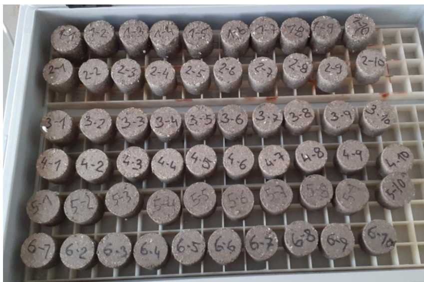
Obr. 2: Vzorová sada vzorků - válečky po 7 dnech zrání ve vlhkém prostředí
