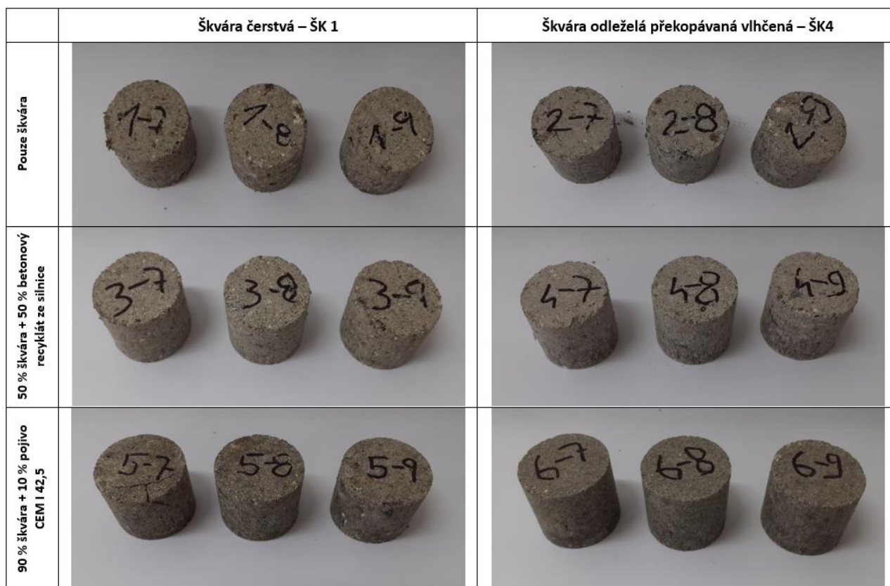
Obr. 4: Stav zkušebních těles po 6. měsících uložení v suchém prostředí
