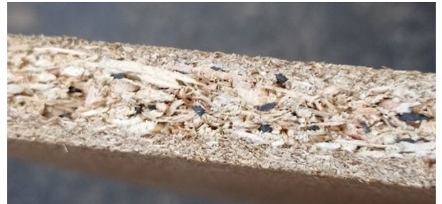
Obrázok 1 Vylisovaná trojvrstvová drevotriesková doska s 10% obsahom plastového odpadu z automobilov
