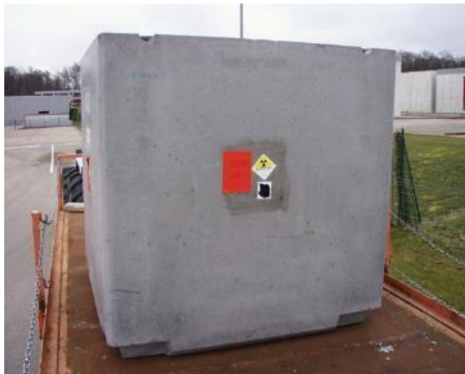
Obr. 2: dlouhodobě funkční obaly NAO (beton) obaly (ocel) (ANDRA)
