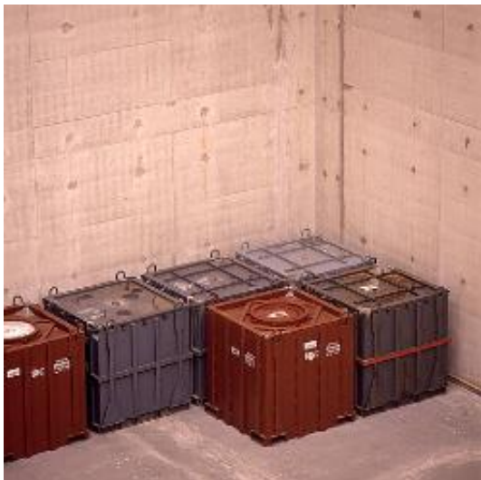
Obr. 1: Konstrukce obalů NAO s krátkou životností
