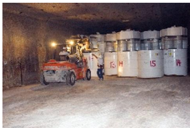
Obr. 18: Plnění kontejneru pro ukládání odpadu sudy s RAO (BGE)
