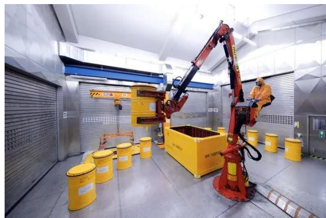
Obr. 18: Plnění kontejneru pro ukládání odpadu sudy s RAO (BGE)
