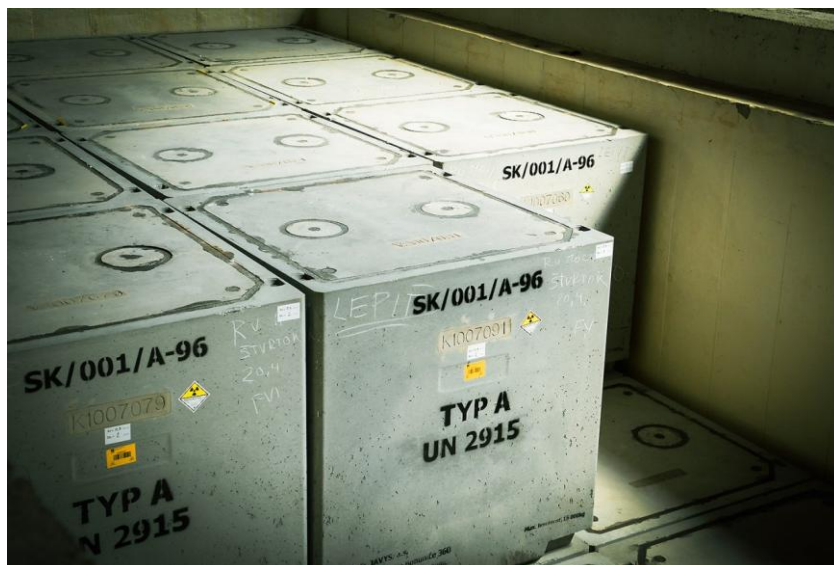
Obr. 6: Betonový přebal obsahující sudy s LLW (JAVYS) a obal LLW (SÚRAO)
