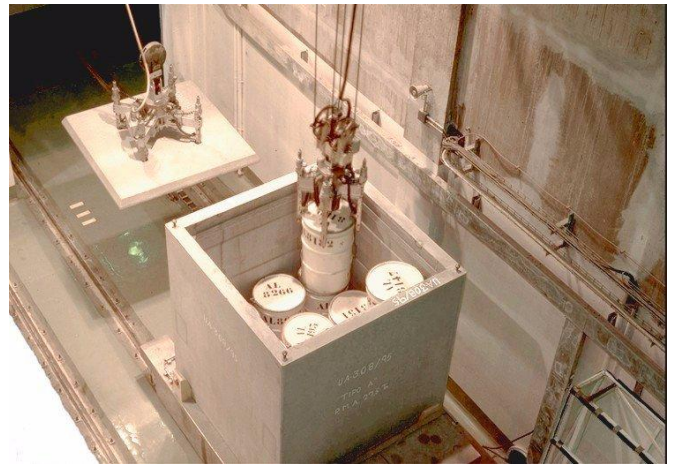
Obr. 9: Vkládání ocelových sudů do betonového kontejneru (ENRESA) [13]
