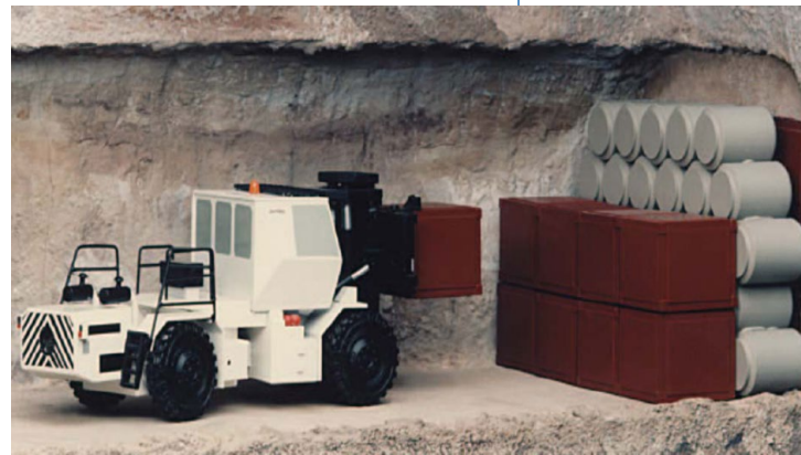
Plánované umístění kontejnerů v úložných koridorech (BGE)
