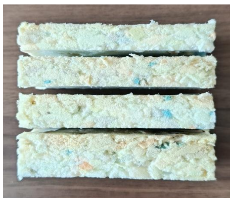
Obr. 5 Výška vzoriek (a hustota) je závislá od nastavenia jednotlivých technologických parametrov
