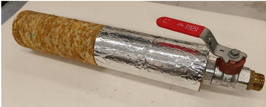
Obr. 12 Tvarový diel tepelnej izolácie potrubia (bez fólie / s hliníkovou fóliou)
